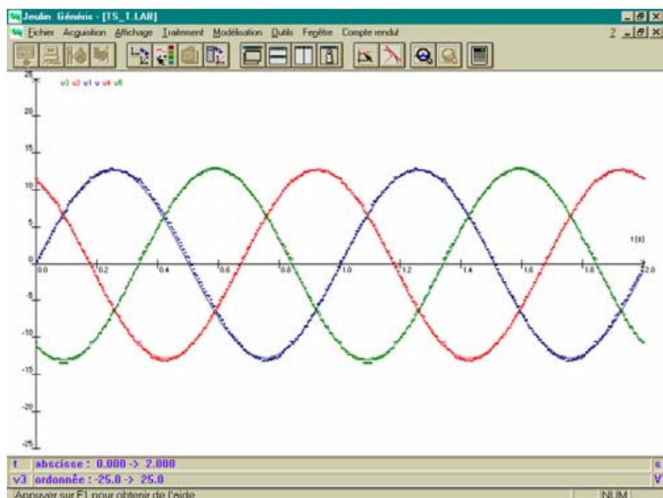
Vérifier que  $v_1(t) + v_2(t) + v_3(t) = 0$  ( $\vec{V}_1 + \vec{V}_2 + \vec{V}_3 = \vec{0}$ ).
