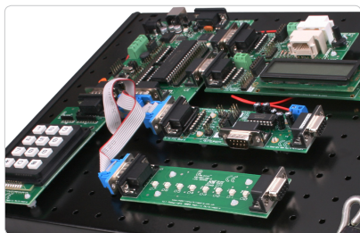
Exemple de système à E-blocks
